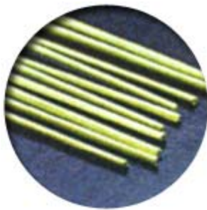
巻き込んで直径 2mm 程のストロー状に成型し、撥水加工して…
